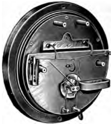
Abb. 438. Hitzdraht-Strommesser von Hartmann & Braun.
